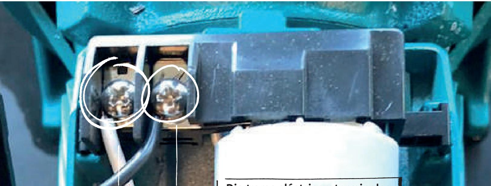
**Diagrama eléctrico y terminales para conexiones U1 y W2**
